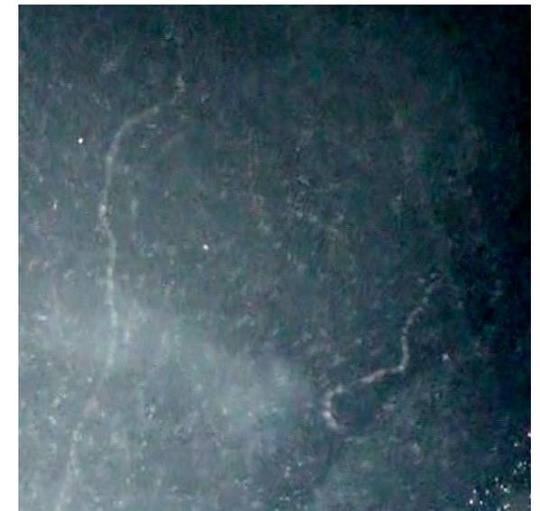
上図の飛跡は御影石から捕集したラドン（恐らく $^{222}\text{Rn}$ ）の $\alpha$ 線によるもの。太く直線的な飛跡を示す。
