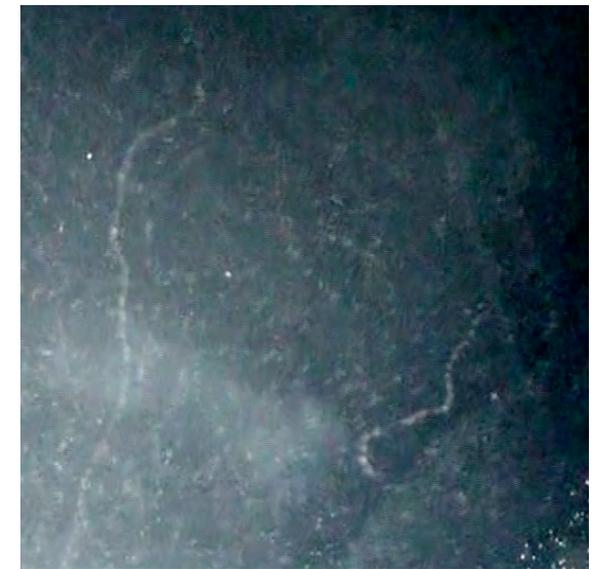
上図の飛跡は御影石から捕集したラドン（恐らく $^{222}\text{Rn}$ ）のα線によるもの。太く直線的な飛跡を示す。
