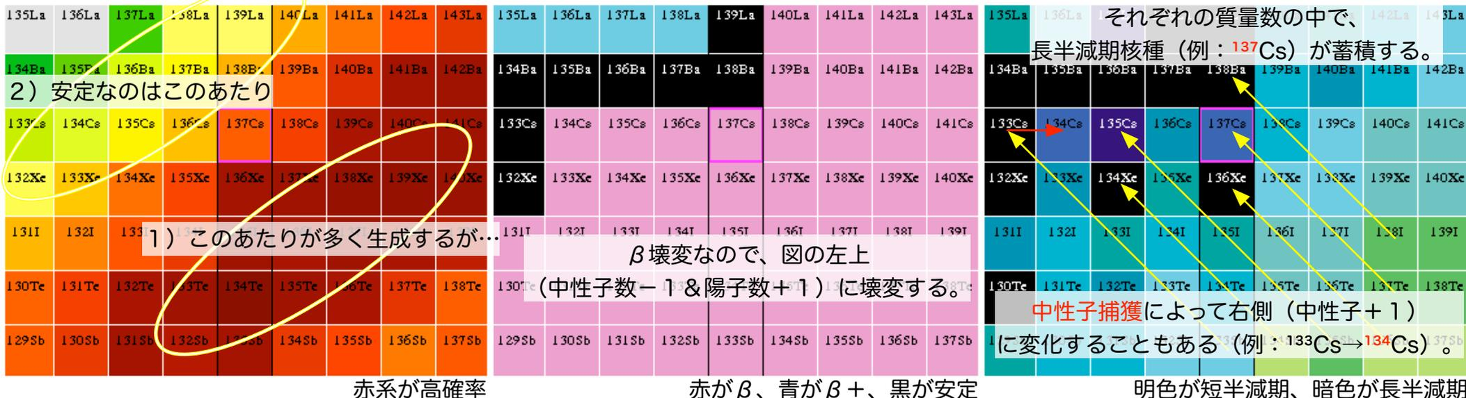
$^{235}\text{U}$ や $^{239}\text{Pu}$ の陽子：中性子比は約1:1.6なので、核分裂で生成した二つの原子核も陽子：中性子比は約1:1.6である。
